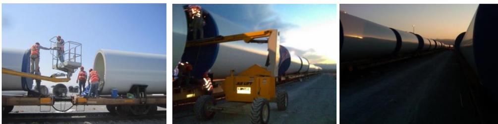
Carga y labores de supervisión de acuerdo a control de calidad de los distintos fabricantes de las torres eólicas a nivel mundial, trabajamos en el trincado (Aseguramiento y amarre) autorizado por la AAR (Assosiation of American Railroad).
